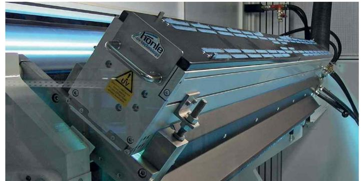
UV 중압 램프의 적용 분야는 이 램프의 특성만큼 다양합니다. 다양한 수처리 분야에서 미생물을 불활성화하여 재생산을 못하게 합니다. 프린팅 분야에서 고속 프린팅 자외선 반응 잉크의 광개시제 네트워크의 생성을 도와줍니다.
